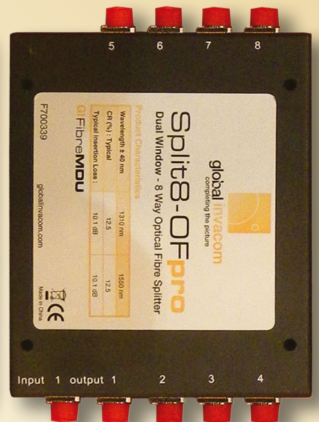
■ GlobalInvacom ha modificato il partitore ottico con spinotti: i cavi ottici di collegamento ora possono essere direttamente connessi al partitore.
