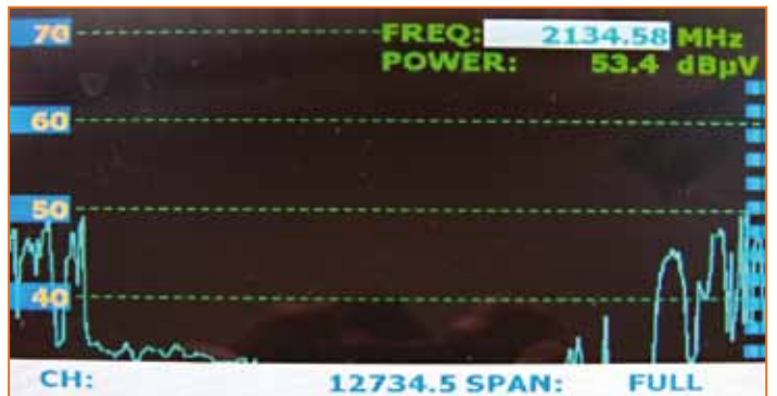
Spettro di NSS7 22° Ovest con un LNB coassiale |
