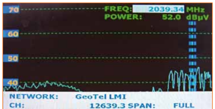
Spettro di ABS1 75° Est con un LNB coassiale |
