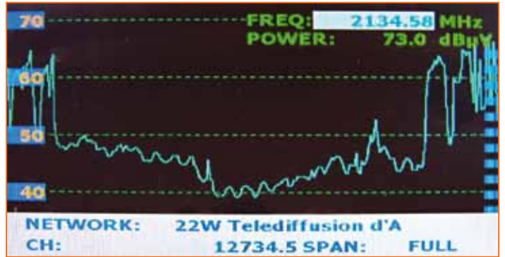
Spettro di NSS7 22° Ovest con LNB Invacom |
