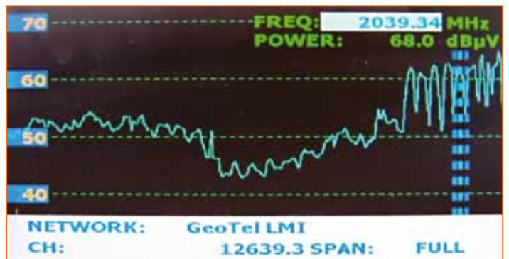
Spettro di ABS1 75° Est con LNB Invacom |
