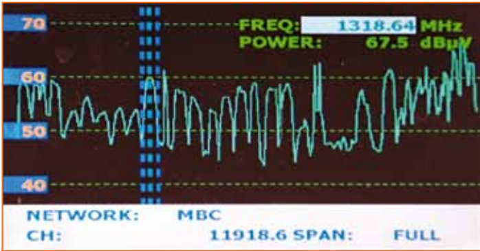
Spettro di BADR 26° Est con LNB Invacom |
