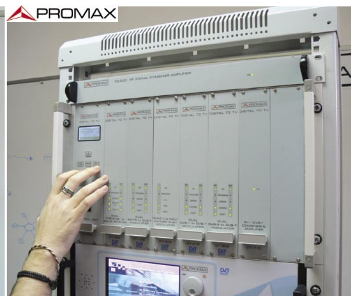
■ La teoria viene dimostrata mediante un collegamento reale: ogni slot rappresenta una possibile sorgente di segnale. Dall'altro lato si ottiene un segnale combinato DVB-T.
