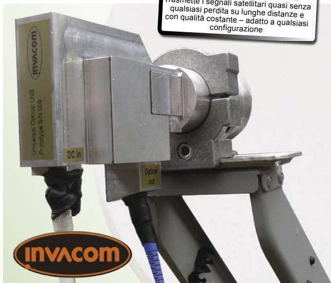
LNB ottico da Global Invacom - il nono di soli dieci prototipi di LNB costruiti a mano e completamente funzionanti.
