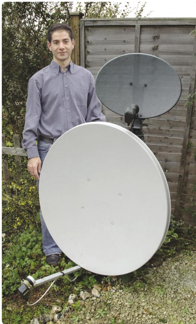
▲ Alan a casa di fronte al suo sistema di ricezione. Egli usa una piccola antenna per ricevere il pacchetto di Sky e l'antenna più grande per analizzare il cielo. Ha programmato Dishpointer; un tool che combina l'azimut e l'elevazione con Google Maps per il posizionamento sulla terra e SatcoDX con la sua base dati satellitare globale.
