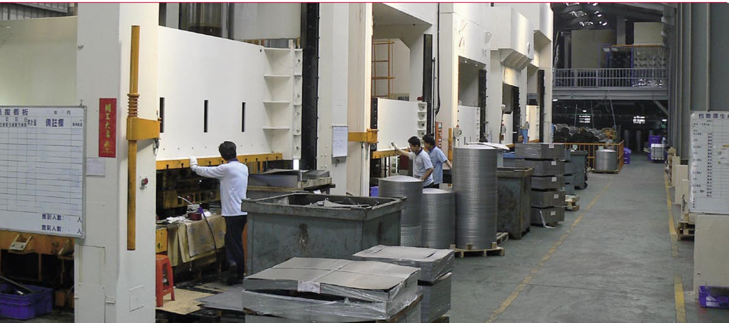
Il reparto presse: il foglio di metallo presagomato (sul pallet in primo piano) viene disposto piatto sulla pressa e ne esce con la forma di un'antenna offset.
